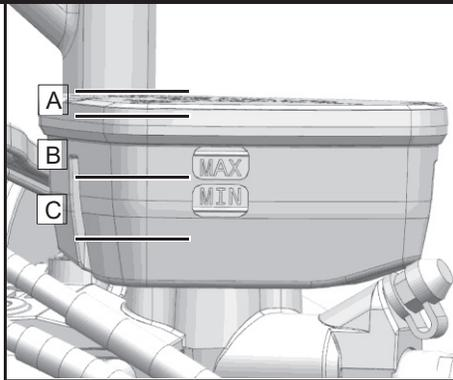
Depósito de líquido del freno delantero
